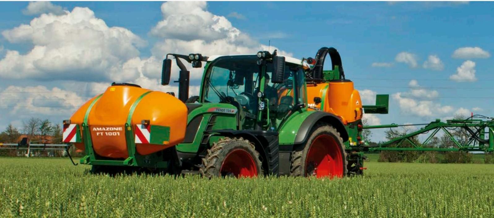
За счет фронтального бака FT объём бака навесного опрыскивателя UF можно очень просто увеличить на 1.000 л. Благодаря компактной конструкции фронтальный бак является идеальным решением для увеличения вместимости UF.
