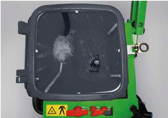
С инжектором Power Вы достигнете большой производительности заполнения. Это такой же профессиональный промывочный бак, как на прицепном опрыскивателе UX.
