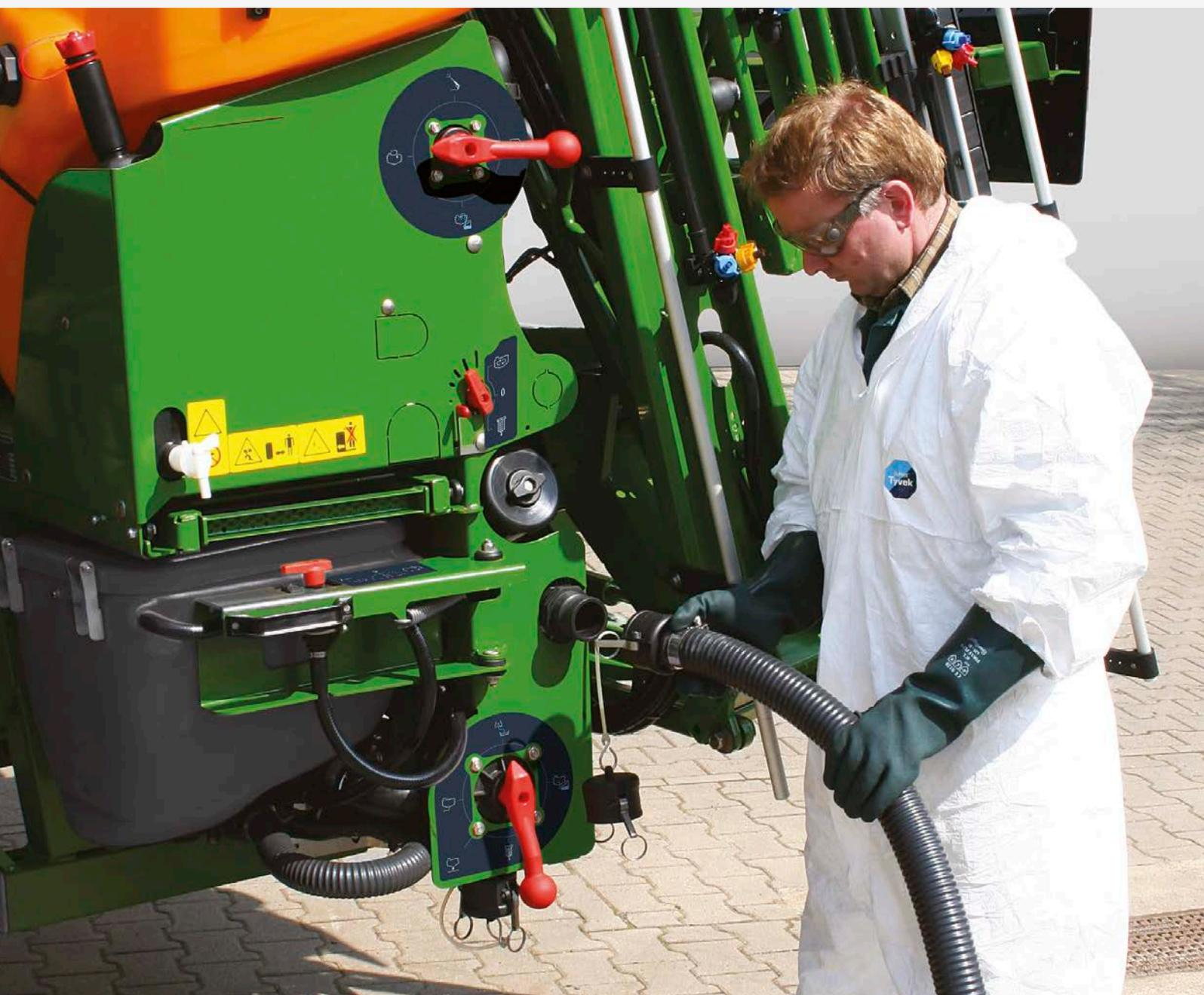
✓ **Заполнение при помощи всасывающего шланга**
